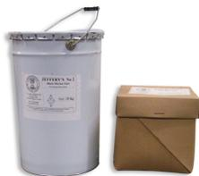
Livré sous forme solide en pot. Cassez des morceaux et les faire chauffer pour ramollir la pâte. Utilisé traditionnellement pour les joints de pont et les cales. Mélange de bitume oxydé et d'asphalte naturel.
