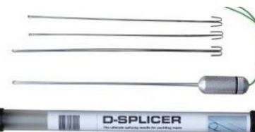
Aiguilles à long chat de matelotage pour épissures sur cordage moderne. 2 aiguilles de 1mm, longueur 24cm et 2 aiguilles de 1.5mm, longueur 26cm.
