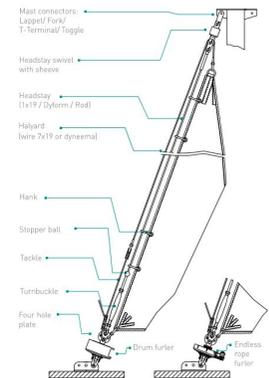
Cette gamme d'emmagasineur et d'enrouleur en Inox est sobre robuste et performante. Idéale pour un bateau classique cherchant l'élégance et la performance. Pour voile de 10 à 75M<sup>2</sup>. Possibilité de garder la voile sur mousqueton ou de cacher le tambour sous le pont. Demandez nous un devis.
